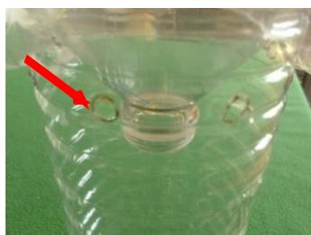
6 – Réalisez, à l'aide d'un fer à souder ou d'une pointe chaude des trous de 5 à 5.5 mm entre la chambre de piégeage et l'entonnoir pour laisser les insectes non ciblés s'échapper.
